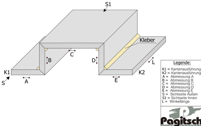
Gipskartonformteil 90° 4V verklebt
