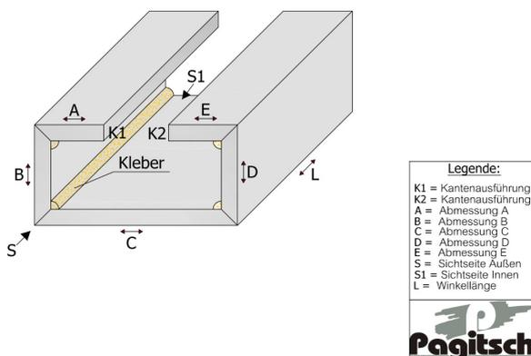
Gipskartonformteil 90° 4V verklebt
