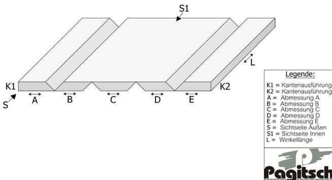
Gipskartonformteil 90° 4V verklebt
