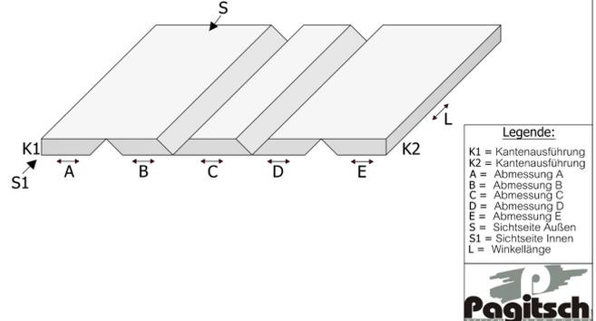
Gipskartonformteil 90° 4V verklebt
