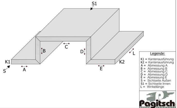
Gipskartonformteil 90° 4V verklebt
